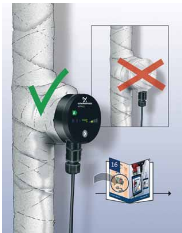
5. ábra Szivattyúház szigetelése
