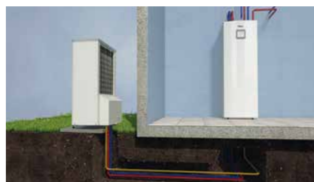
Monoenergiás működési mód AW M vagy AW M S beépített tárolós beltéri egységgel. Az AW M S változat szolár csőkígyót is tartalmaz.
