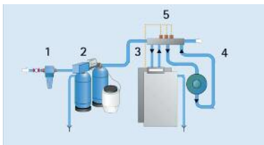
BWT Permaq Pico on-line (nyomás alatti) üzemmódba bekötve
